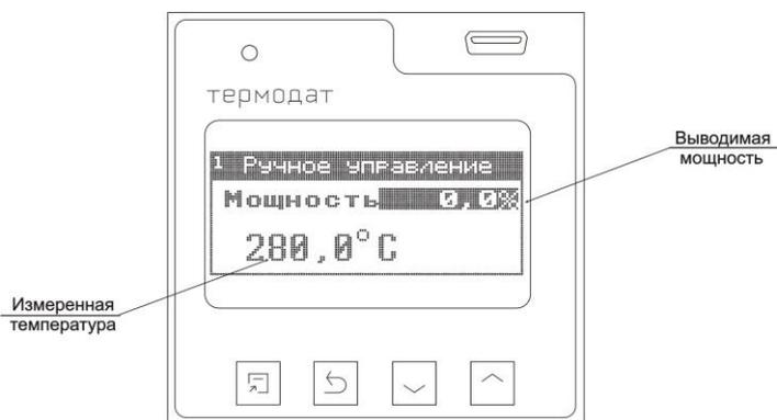
Рисунок 4 - Режим индикации «Ручное управление»
