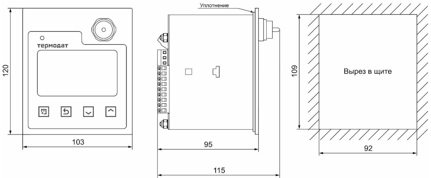
Рисунок 12 – Габаритные размеры основного блока прибора Термодат-25К6/...../F/IP67
