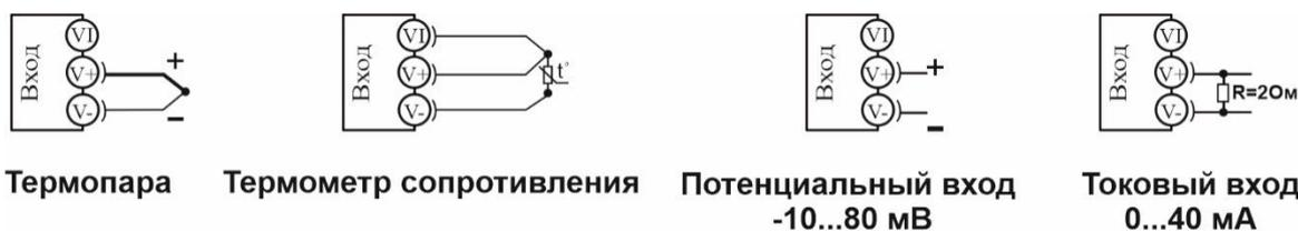
Рисунок 5 – Схемы подключения датчиков
