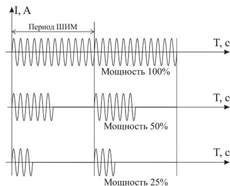
При **методе равномерно распределенных рабочих сетевых периодов (РСП)** ток через нагрузку периодически включается на один или несколько сетевых периодов. Мощность нагревателя испытывает меньшие колебания во времени, чем при использовании ШИМ. Этот метод очень хорош в лабораторных условиях при малых мощностях нагревателя. Не используйте метод при мощностях более 5 кВт. Недопустимо использование метода РСП при индуктивной нагрузке.
