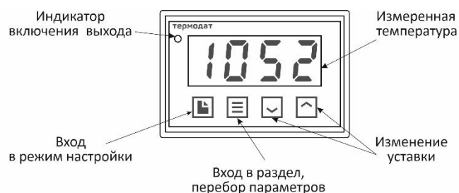
Рисунок 8 – Описание индикаторов и кнопок управления прибора 10М7 - Р4
