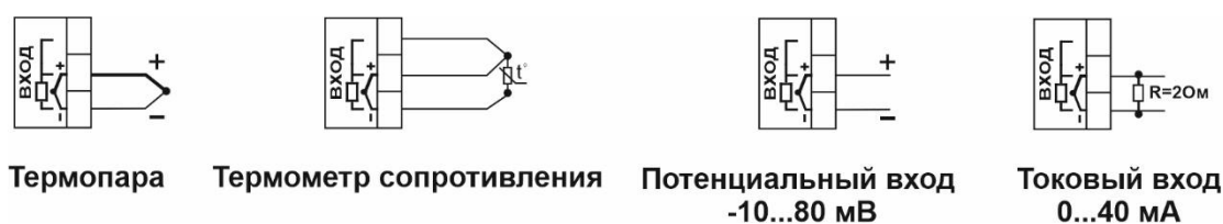
Рисунок 10 – Схема подключения датчиков температуры
