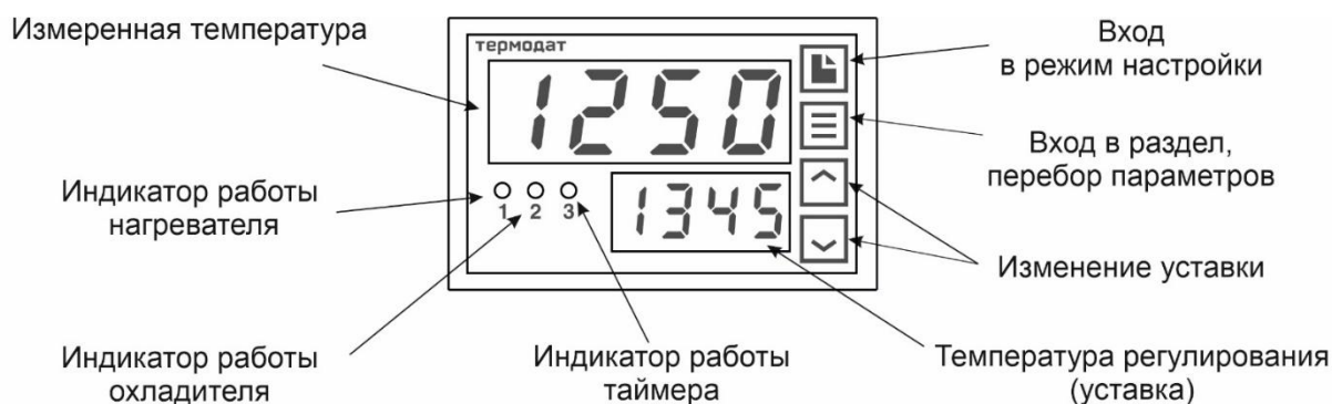
Рисунок 12 – Описание индикаторов и кнопок управления прибора Термодат-10K7-P4
