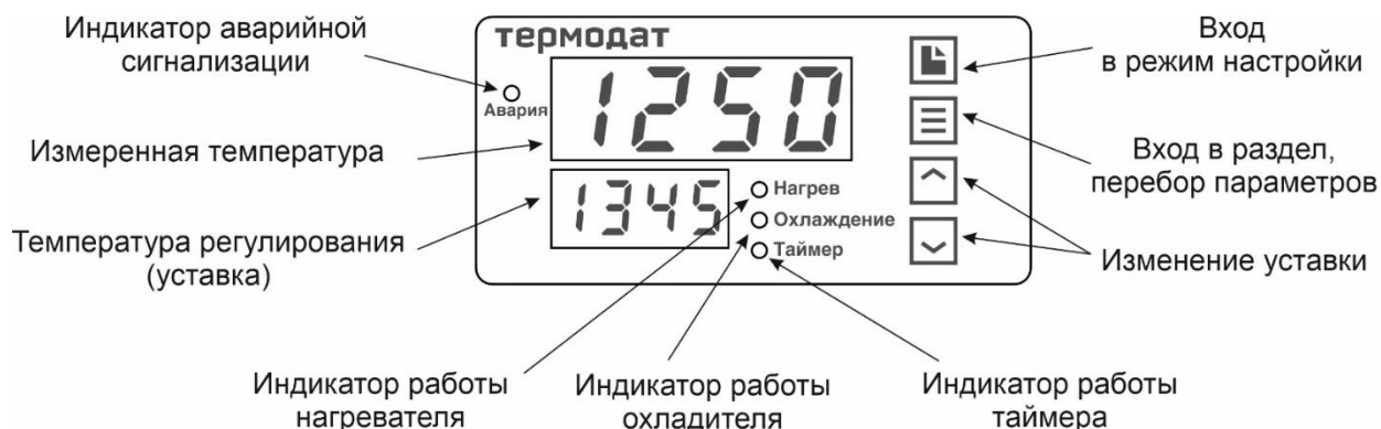
Рисунок 10 – Описание индикаторов и кнопок управления прибора Термодат-10K7-H
