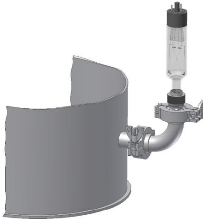
Схема подключения датчика ПМТ-2 к вакуумной системе
