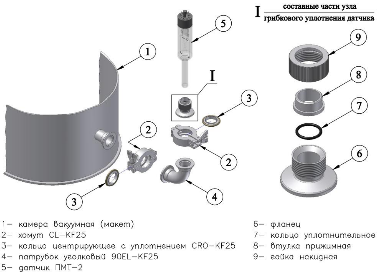
Схема подключения датчика ПМТ-2 к вакуумной системе в разборе
