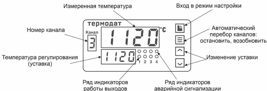
Рисунок 8 – Описание индикаторов и кнопок управления приборов 11М6-Н...
