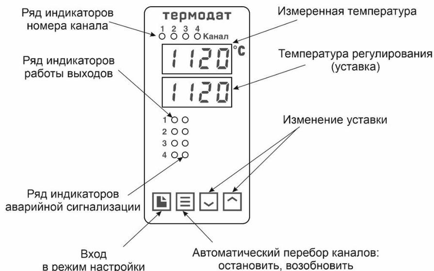
Рисунок 7 – Описание индикаторов и кнопок управления приборов 11М6-В...
