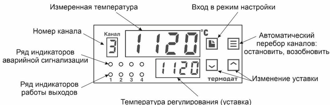
Рисунок 6 – Описание индикаторов и кнопок управления приборов 11М6-Р6...
