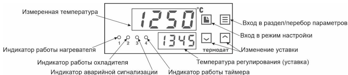
Рисунок 8– Описание индикаторов и кнопок управления прибора 12К6-Р6...
