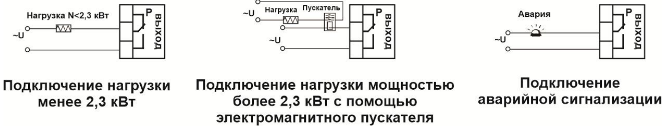
Рисунок 6 – Схемы подключения релейных выходов
