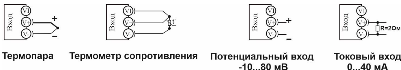
Рисунок 7 – Схемы подключения датчиков
