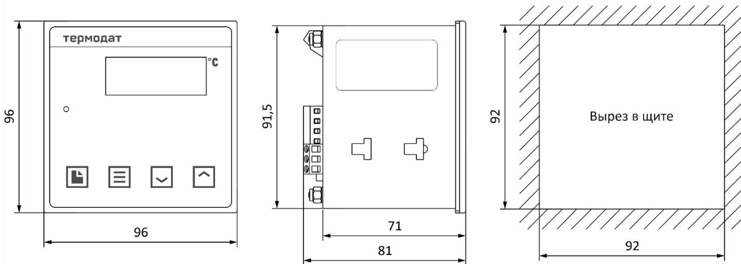
Рисунок 19 – Габаритные размеры прибора 10М7-А
