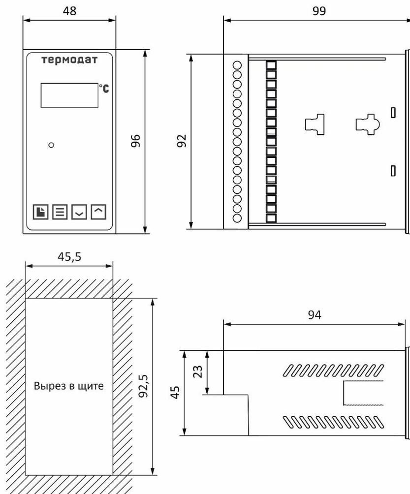
Рисунок 23– Габаритные размеры прибора 10M7-В
