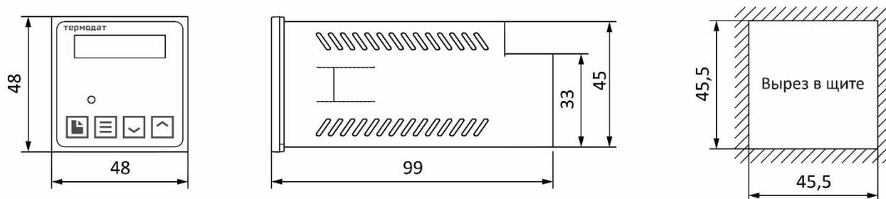
Рисунок 22 – Габаритные размеры прибора 10M7-K
