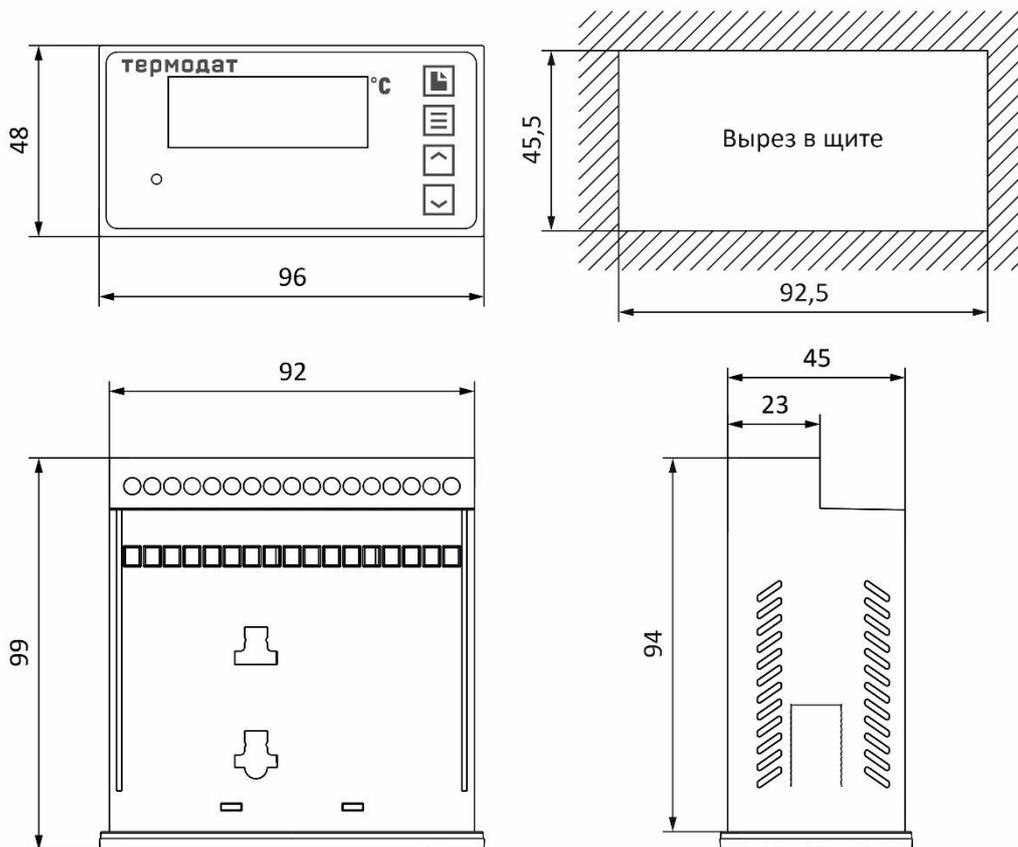
Рисунок 24 – Габаритные размеры прибора 10M7-Н
