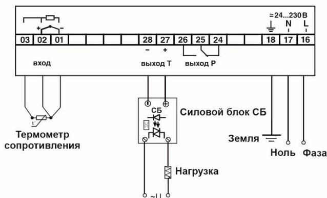
Рисунок 18 – Типовая схема подключения при использовании Т выхода.
