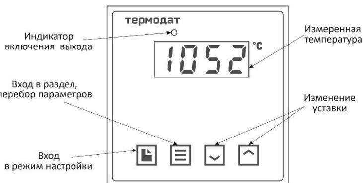
Рисунок 8 – Описание индикаторов и кнопок управления прибора 10М7-М
