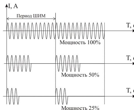
При методе **равномерно распределенных рабочих сетевых периодов (PCП)** ток через нагрузку периодически включается на один или несколько сетевых периодов. Мощность нагревателя испытывает меньшие колебания во времени, чем при использовании ШИМ. Этот метод очень хорош в лабораторных условиях при малых мощностях нагревателя. Не используйте метод при мощностях более 5 кВт. Недопустимо использование метода PCП при индуктивной нагрузке.
