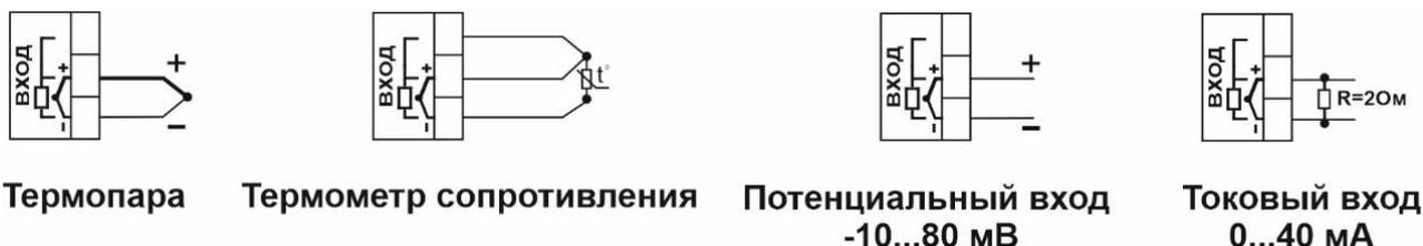
Рисунок 14 – Схема подключения датчиков температуры
