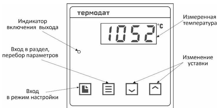
Рисунок 7 – Описание индикаторов и кнопок управления прибора 10М7-А
