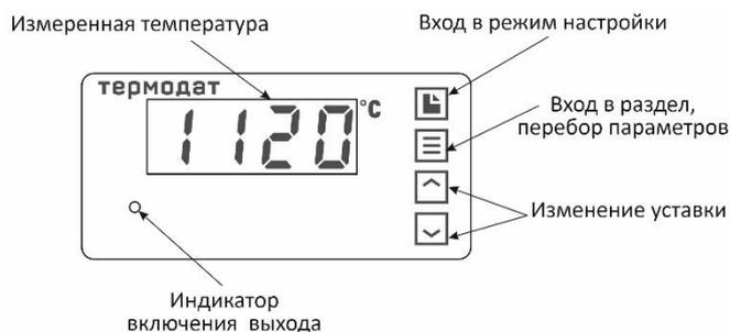
Рисунок 12 – Описание индикаторов и кнопок управления прибора 10М7 - P4
