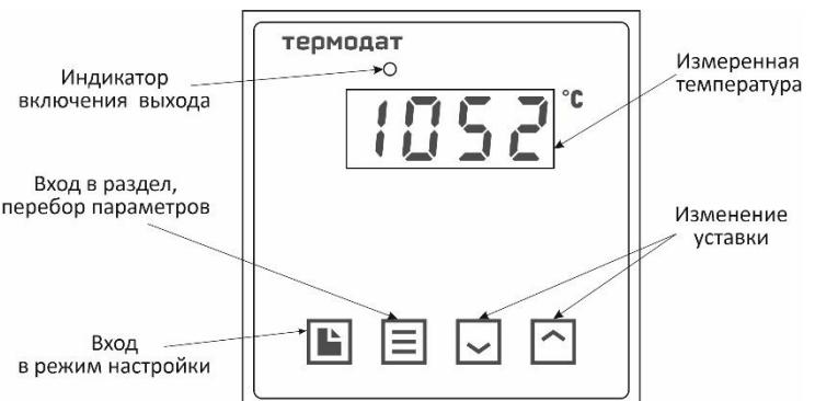
**Рисунок 8 – Описание индикаторов и кнопок управления прибора 10M7-М**
