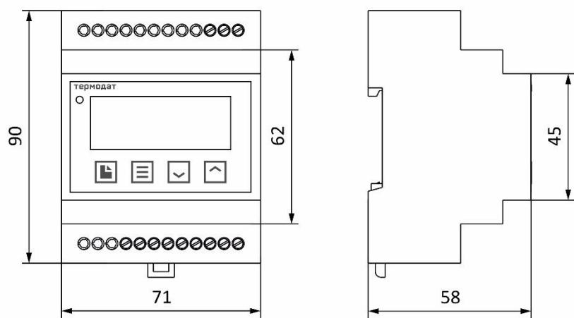
Рисунок 21 – Габаритные размеры прибора 10М7-Р4
