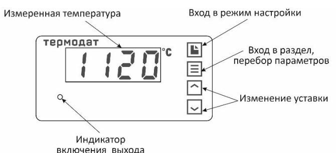
**Рисунок 12 – Описание индикаторов и кнопок управления прибора 10M7 - Р4**
