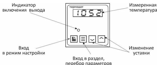
**Рисунок 9 – Описание индикаторов и кнопок управления прибора 10M7 - К**
