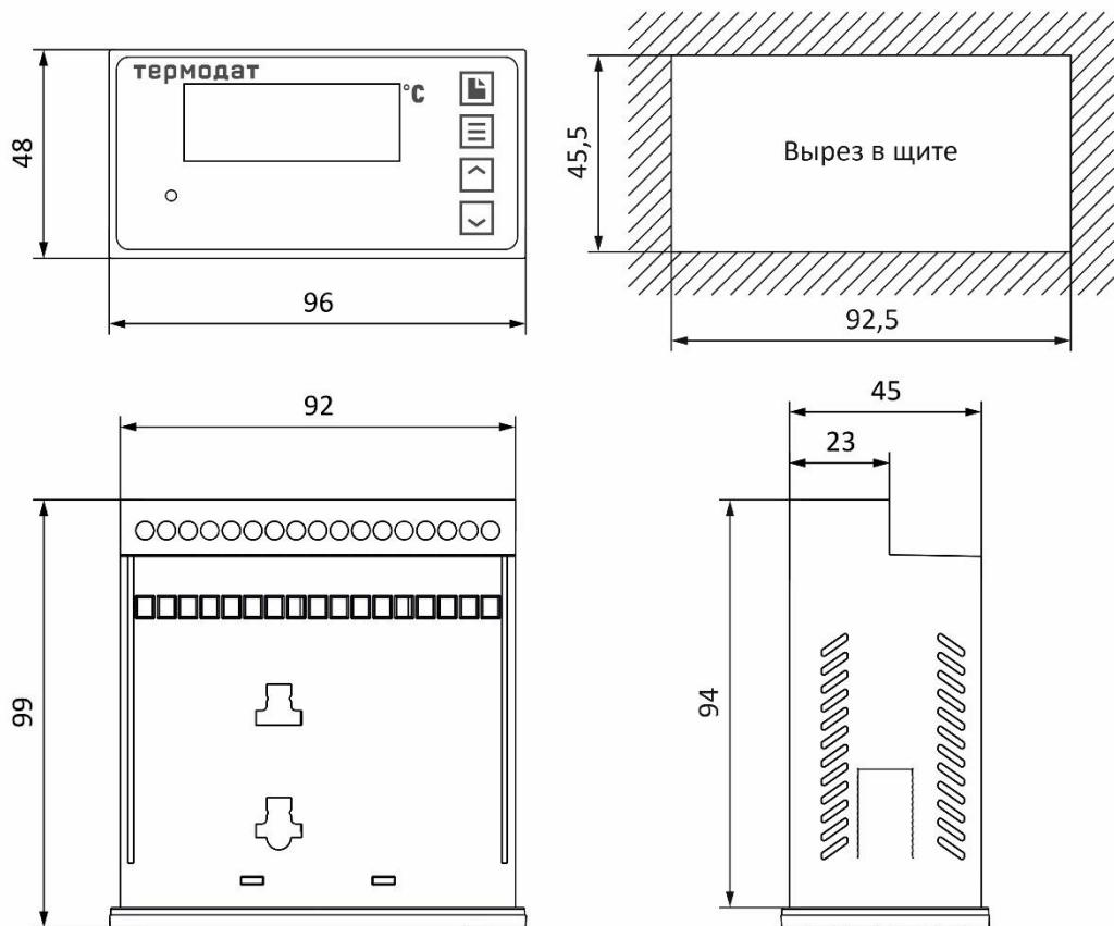
Рисунок 24 – Габаритные размеры прибора 10М7-Н
