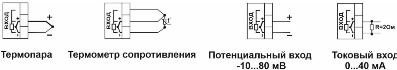
Рисунок 14 – Схема подключения датчиков температуры
