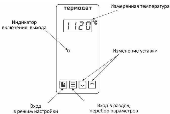
**Рисунок 11 – Описание индикаторов и кнопок управления прибора 10M7 - К**
