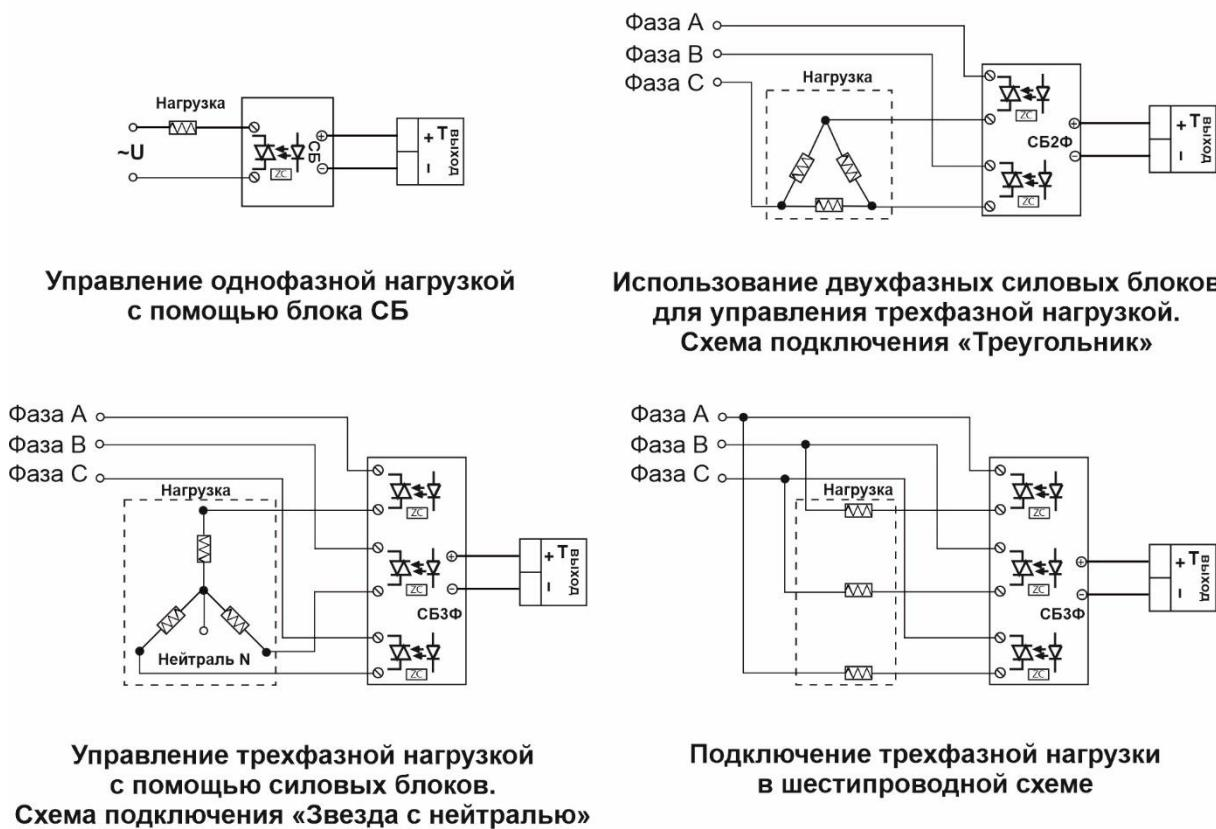
Рисунок 16 – Схемы подключения транзисторного выхода
