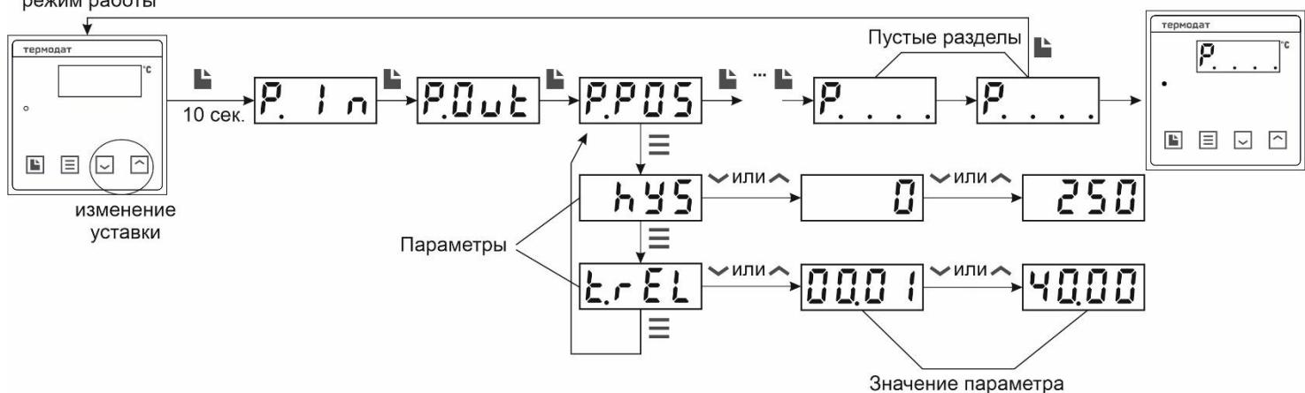
Рисунок 13 – Схема расположения разделов (групп параметров) и параметров в режиме настройки
