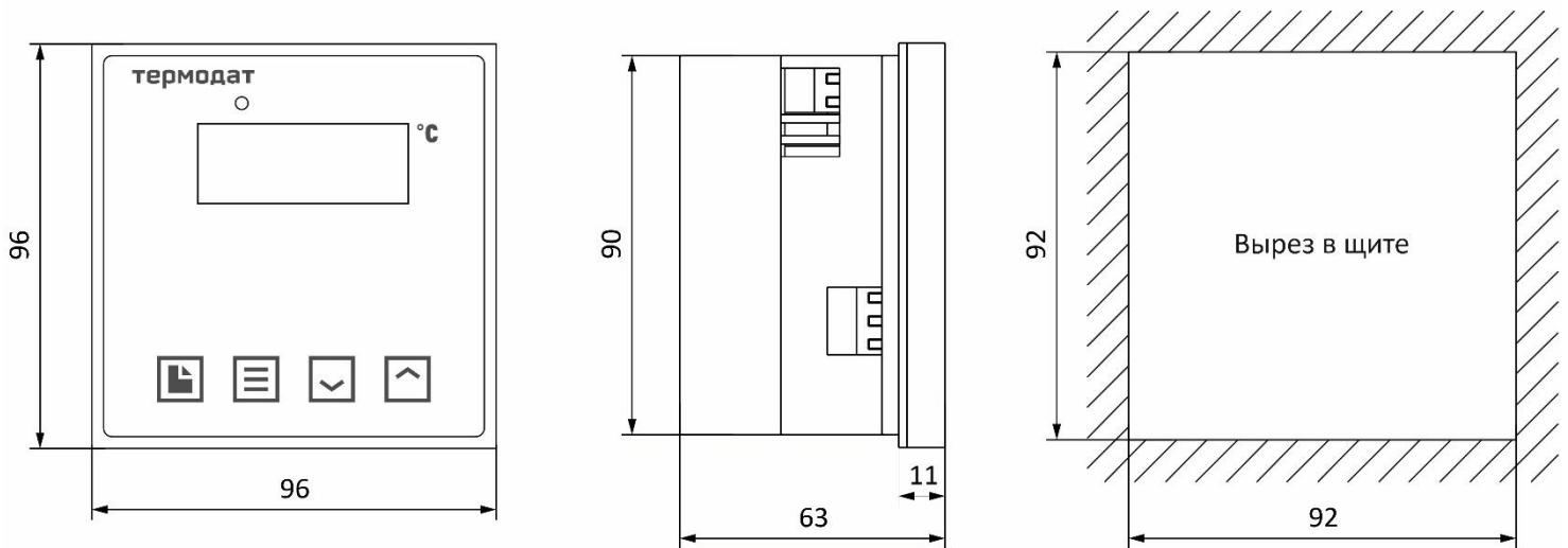
Рисунок 20 – Габаритные размеры прибора 10М7-М
