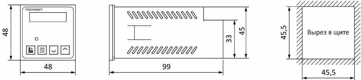
Рисунок 22 – Габаритные размеры прибора 10М7-К
