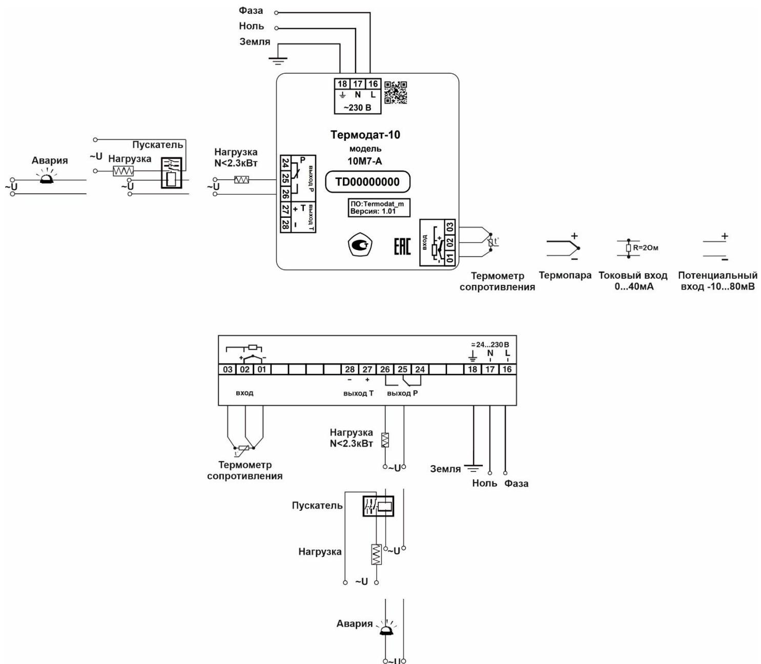
Рисунок 17 – Типовая схема подключения при использовании Р выхода.
