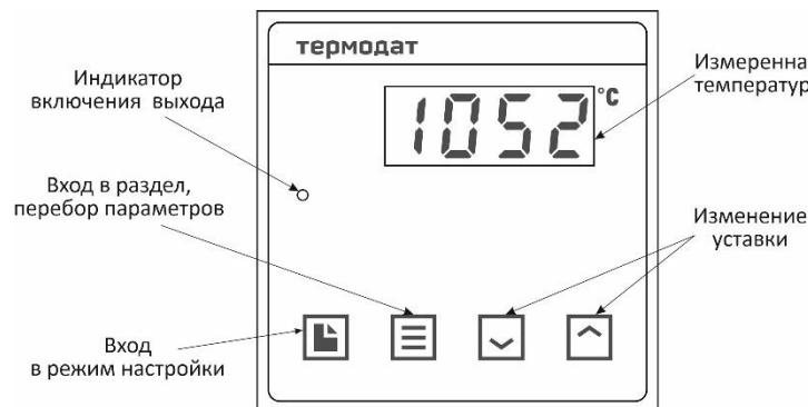
**Рисунок 7 – Описание индикаторов и кнопок управления прибора 10M7-А**
