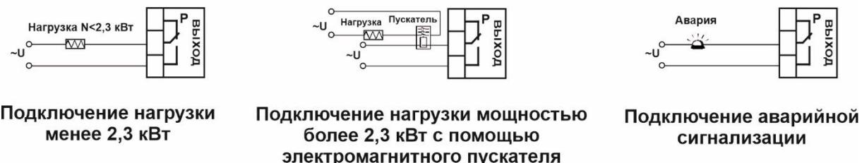
Рисунок 15 – Схемы подключения релейных выходов.
