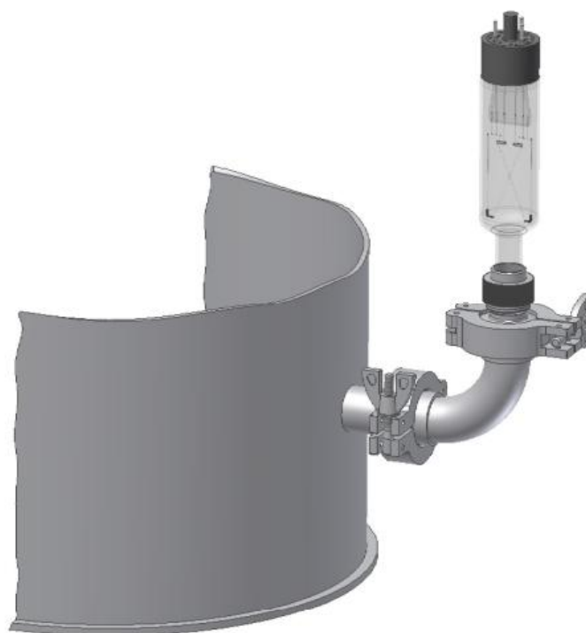
Схема подключения датчика PMT-2 к вакуумной системе
