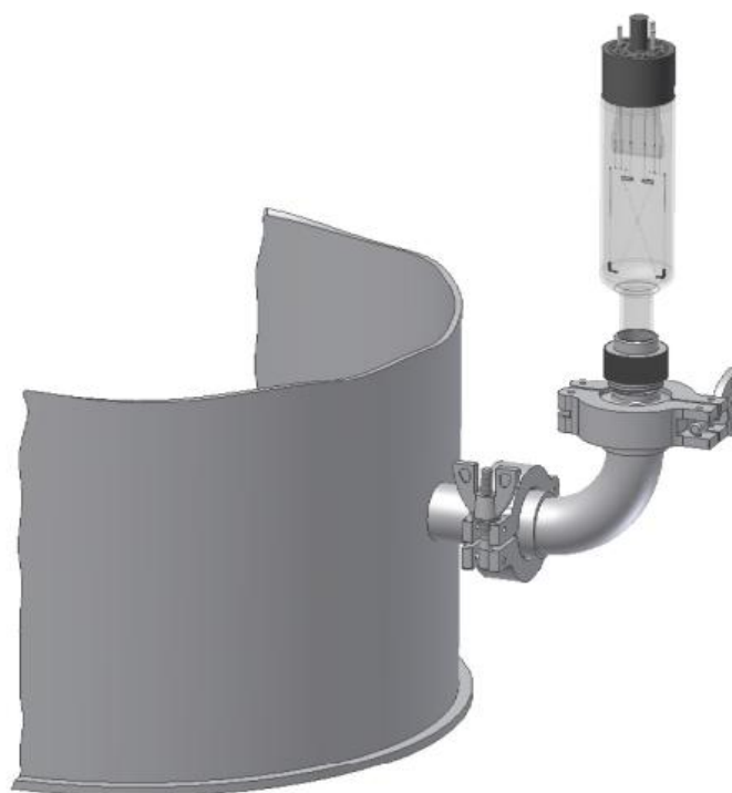
Схема подключения датчика ПМТ-2 к вакуумной системе
