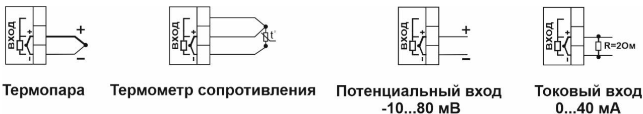
Рисунок 14 – Схема подключения датчиков температуры
