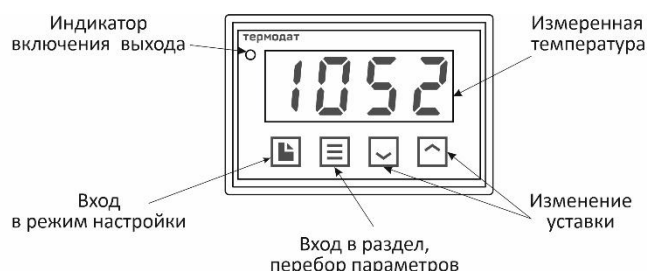
Рисунок 10 – Описание индикаторов и кнопок управления прибора 10М7 - Р4
