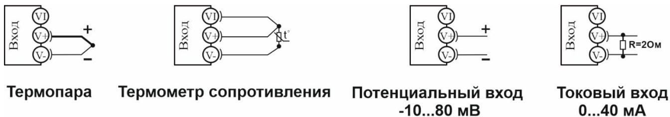
Рисунок 1 - Схемы подключения датчиков
