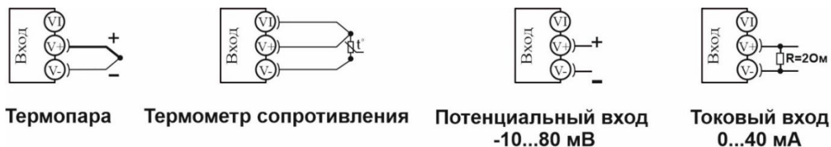
Рисунок 2 – Схемы подключения датчиков
