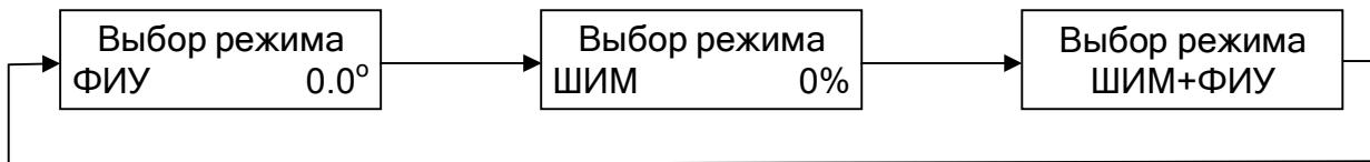
Подтверждение выбора и переход к выбору входа управления производится нажатием кнопки □, а выбор осуществляется опять же кнопками  $\nabla$  и  $\Delta$ . В зависимости от выбранного метода регулирования будет предложено выбрать либо управление для ФИУ, либо для ШИМ. В случае выбора метода ШИМ+ФИУ нужно будет выбрать соответствующий вход управления для каждого из этих методов.
